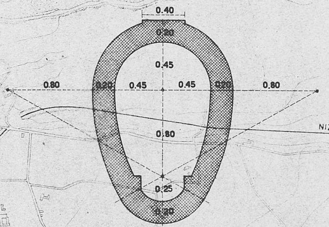
SEZIONE TIPO N°2 - COLLETTORE SECONDARIO
