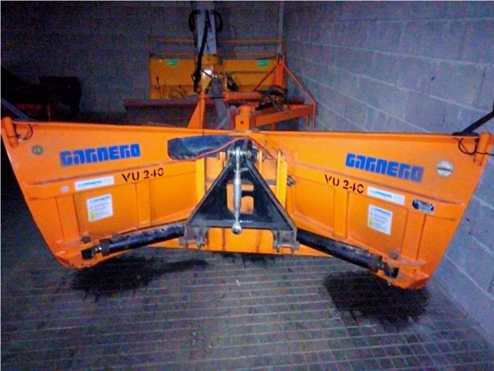
VOMERO SGOMBRANEVE GARNERO MODELLO VU 240 MATRICOLA GV41305 CON LAMA IN GOMMA (COLLAUDATO)
