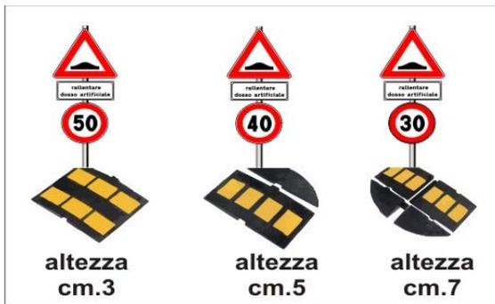
**I tipi a) e b) devono essere realizzati in elementi modulari in gomma o materiale plastico, il tipo c) può essere realizzato anche in conglomerato.**
