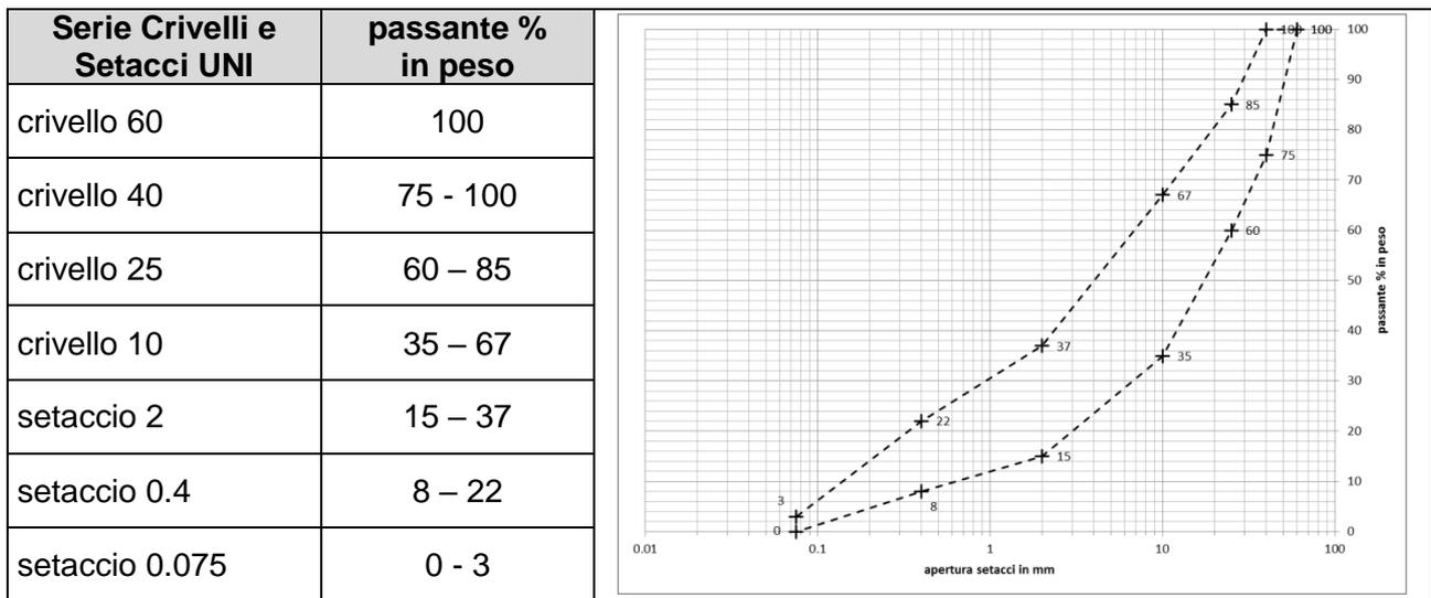
Lo strato di rilevato anticapillare/antigelo, sarà posto in opera in più strati successivi da 25/30 cm c.a. ciascuno regolarizzato con mezzi meccanici e compattato in modo da ottenere densità pari almeno al 95% (Proctor modificata).
