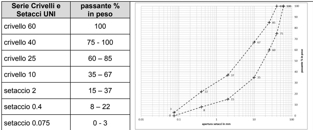
Lo strato di rilevato anticapillare/antigelo, sarà posto in opera in più strati successivi da 25/30 cm c.a. ciascuno regolarizzato con mezzi meccanici e compattato in modo da ottenere densità pari almeno al 95% (Proctor modificata).
