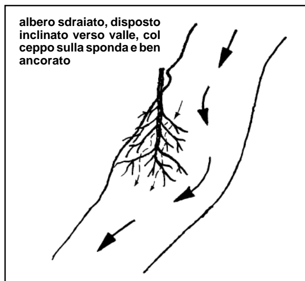
Fig. 31. Miglioramento dell'habitat con alberi sdraiati in alveo. [da SANSONI, 1993, ispirato ad una foto di GORE, 1985]
