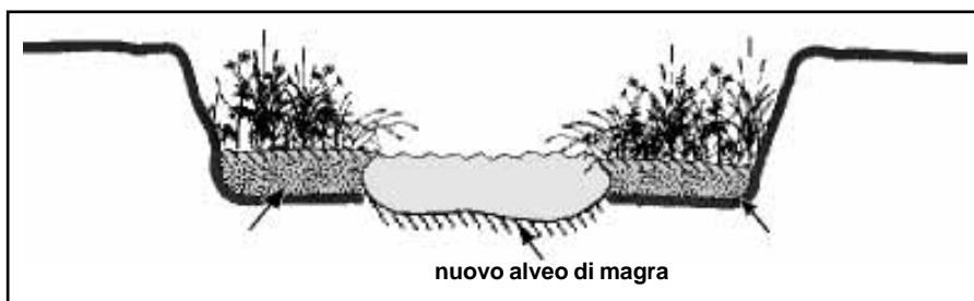
Fig. 48. Le bordure di vegetazione acquatica intrappolano sedimenti e formano col tempo una banchina mentre il canale di corrente si approfondisce. [da DANISH ENVIR. PROTECTION AGENCY, 1995]
